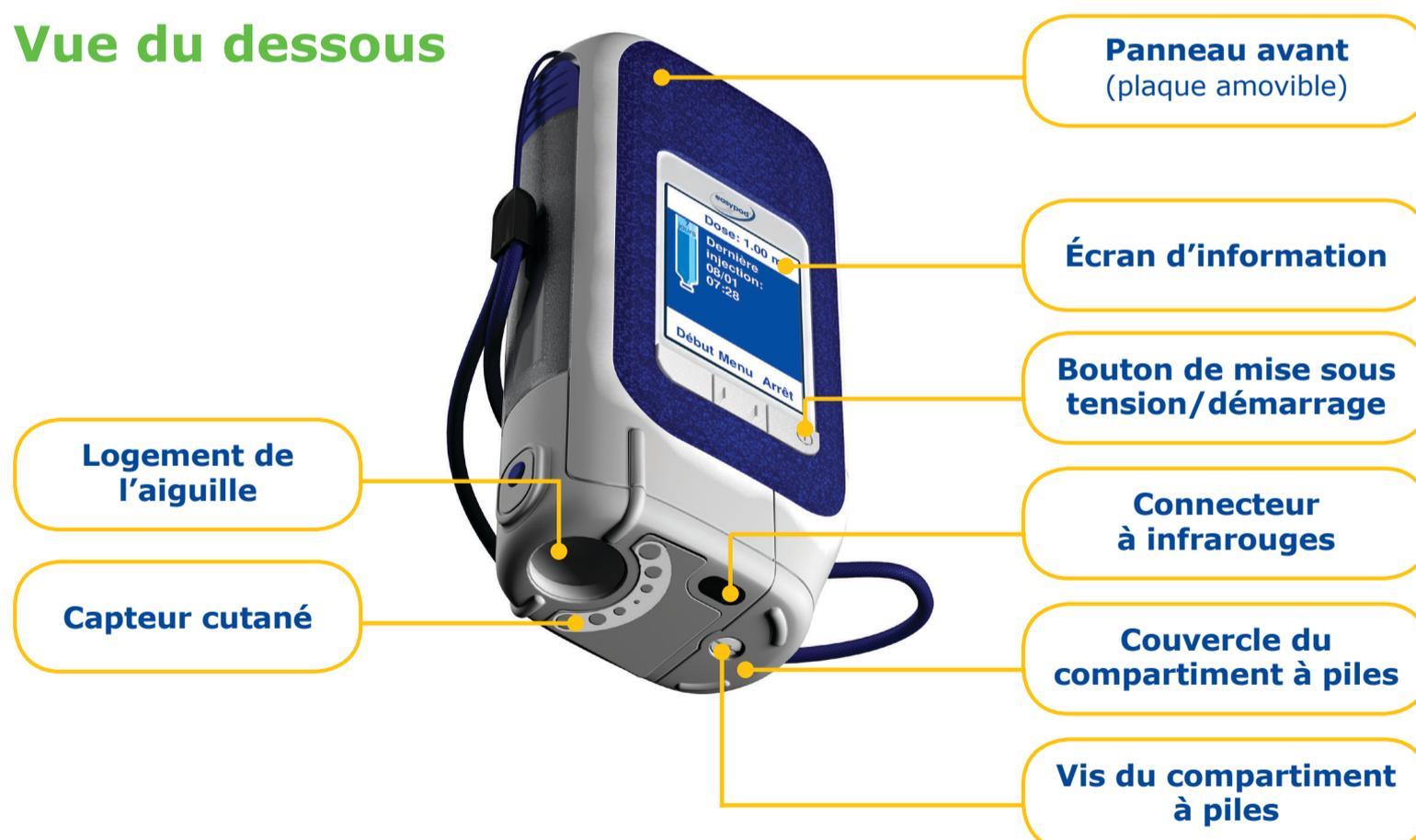
**À retenir : Toujours utiliser la courroie pour manipuler le dispositif easypod; conserver le dispositif à la verticale.**
